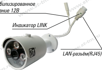
Рис. 1 Схема подключения видеокамеры
