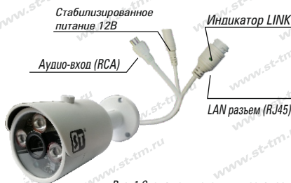
Рис. 1 Схема подключения видекамеры
