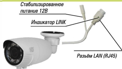
Рис. 1 Схема подключения видекамеры
