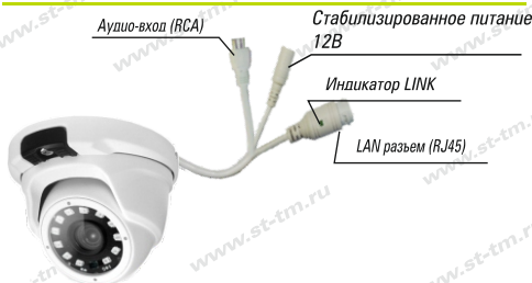
Рис. 1 Схема подключения видеокамеры
