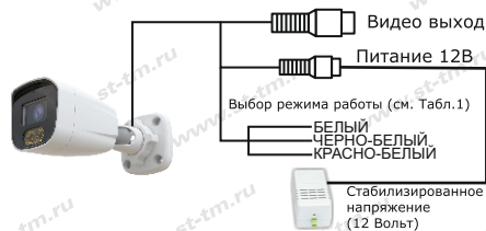
Рис.1 Схема подключения
