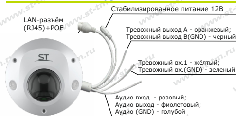
Рис.1 Схема подключения видеокamеры
