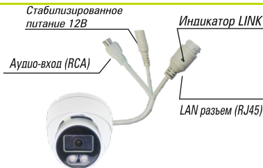
Рис. 1 Схема подключения видеокмеры
