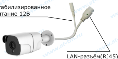
Рис. 1 Схема подключения видеокмеры
