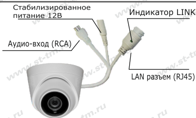
Рис. 1 Схема подключения видеоканалов
