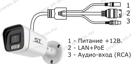
Рис.1 Схема подключения видеокamеры
