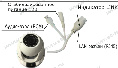
Рис. 1 Схема подключения видеокамеры
