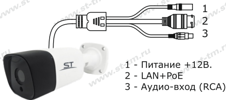
Рис.1 Схема подключения видеокамеры
