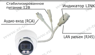
Рис. 1 Схема подключения видеокамеры
