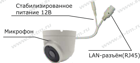
Рис. 1 Схема подключения видеокамеры
