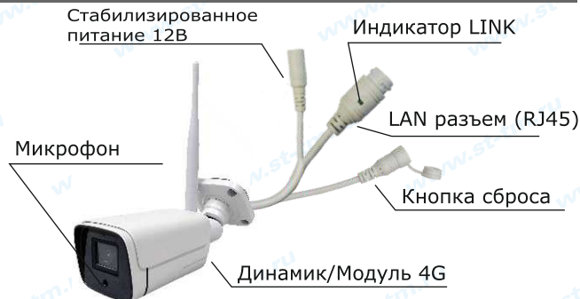
Рис. 1 Схема подключения видеокамеры
