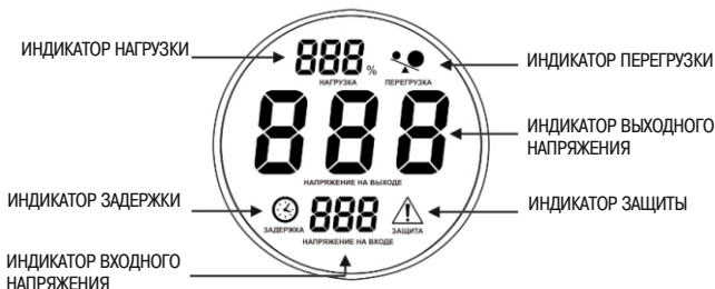
Рисунок 3 – Индикация режимов работы стабилизаторов
