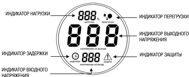
Рисунок 3 – Индикация режимов работы стабилизатора
