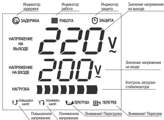
Рис 2. Индикация режимов работы настенных стабилизаторов
