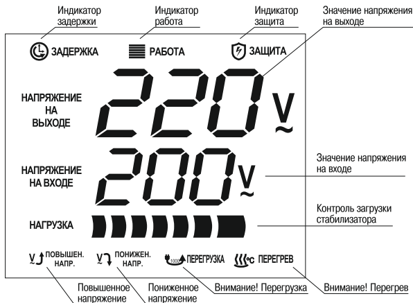
Рис 6. Индикация режимов работы стабилизаторов
