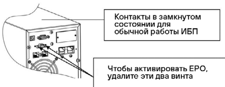
Рисунок 3. Разъем аварийного отключения EPO
