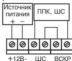
Рисунок 3 – Схема подключения извещателя с объединенными шлейфами сигнализации и вскрытия корпуса
