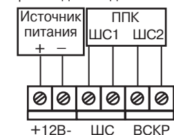
Рисунок 2 – Схема подключения извещателя с отдельными шлейфами сигнализации и вскрытия корпуса
