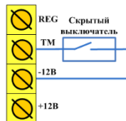
Рисунок 6.5 — Схема подключения скрытого выключателя или кнопки
