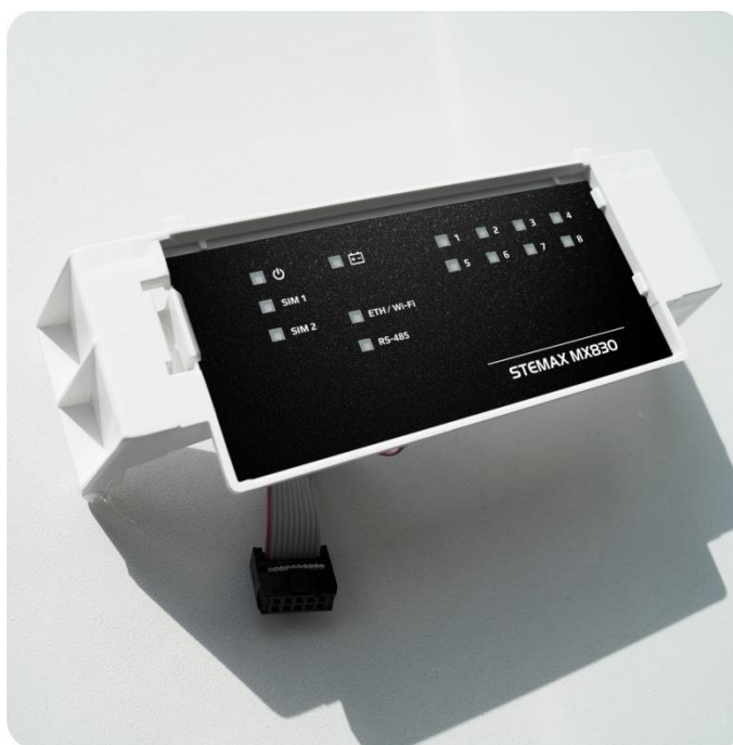
Рисунок 5.4 — Панель индикации контроллера
