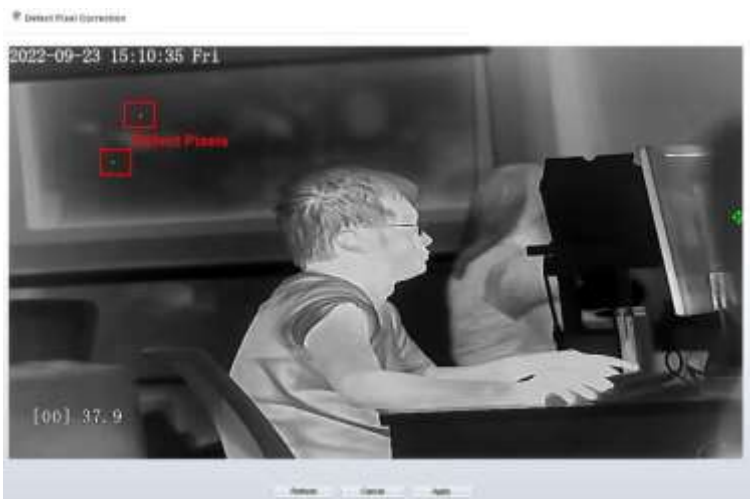
Рисунок 3-13 Коррекция дефектных пикселей
