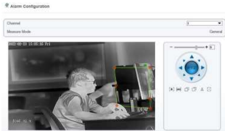
Рисунок 3-5 Интерфейс настройки температурной области
