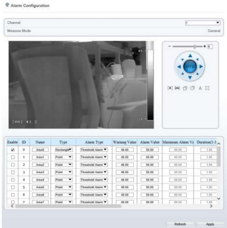
Рисунок 3-4 Конфигурирование тревоги по температуре
