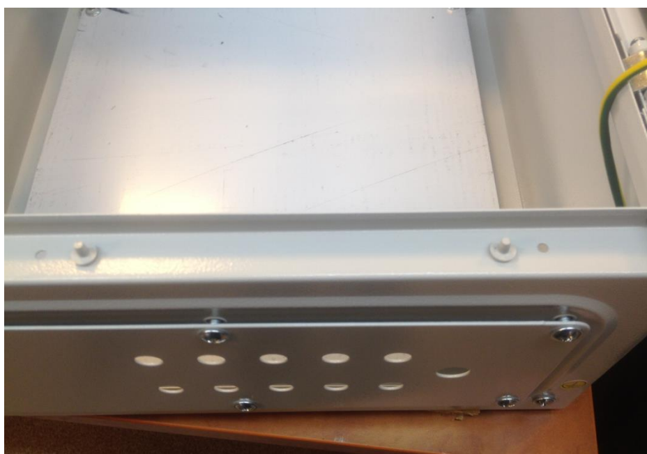
Рис.3.1.2-2 Резиновые заглушки вынуты из отверстий OS.
