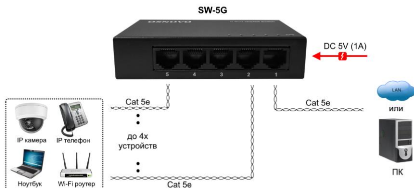
Рис. 4 Типовая схема подключения коммутатора SW-5G.
