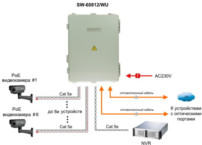
Рис.6 Типовая схема подключения коммутатора SW-60812/WU
