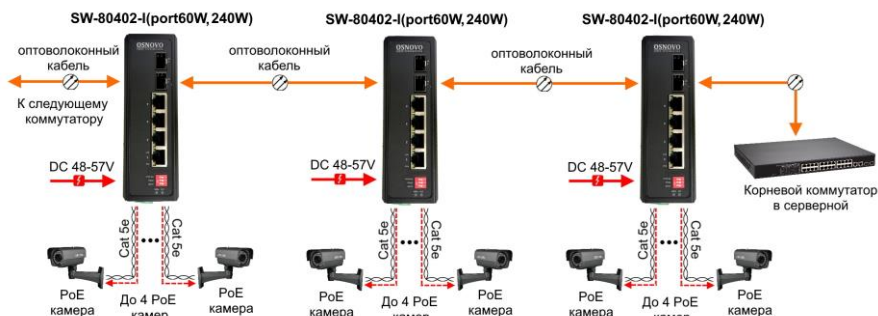
Рис.4 Типовая схема подключения коммутатора SW-80402-I(port60W, 240W)
