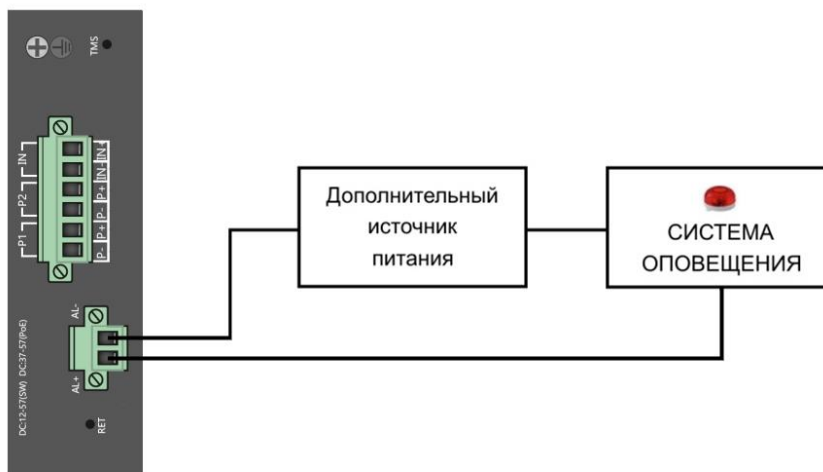
Рис.10 Схема подключения системы оповещения к коммутатору SW-808010/ILS(port 90W,720W)
