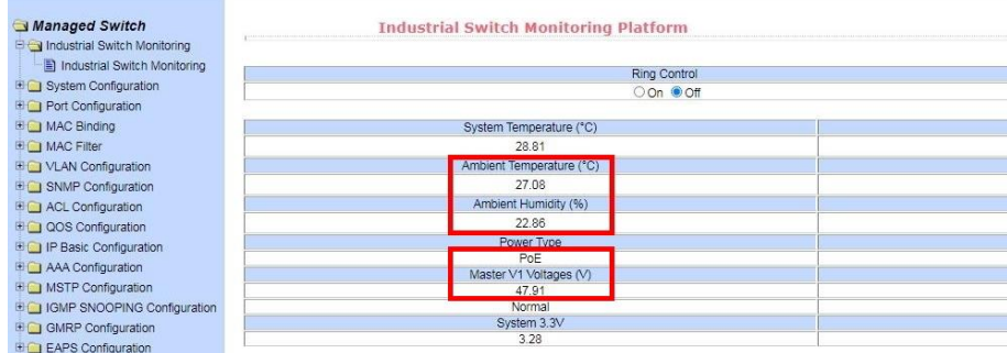
Рис.8 Контроль напряжения питания, параметров температуры/влажности окружающей среды через Web-интерфейс коммутатора
