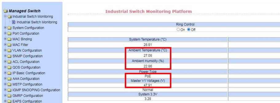
Рис.7 Контроль температуры/влажности, напряжения питания через WEB-интерфейс коммутатора
