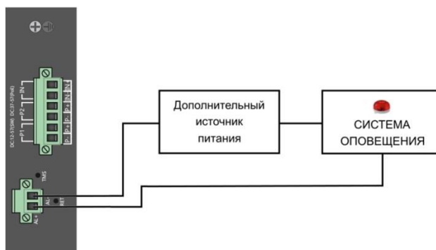
Рис.8 Схема подключения системы оповещения к коммутатору SW-81602/ILS(port 90W, 600W)
