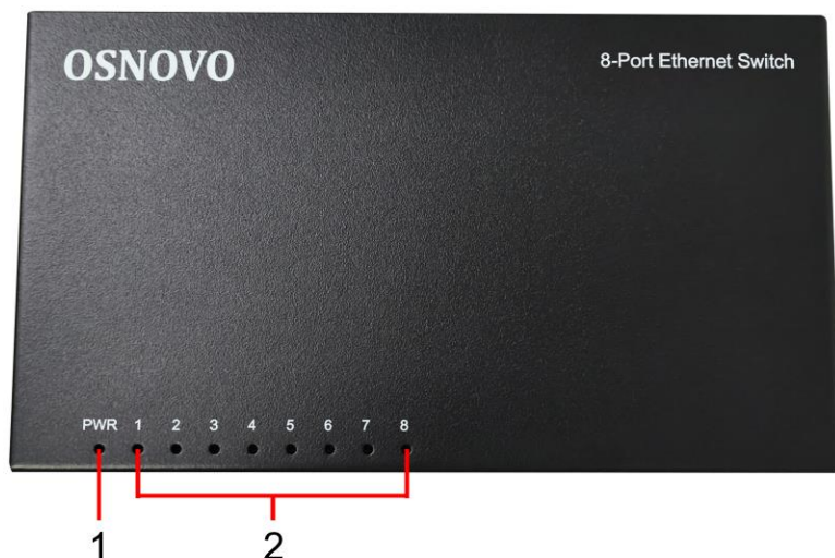
Рис.3 Коммутатор SW-8F, индикаторы на верхней панели.
