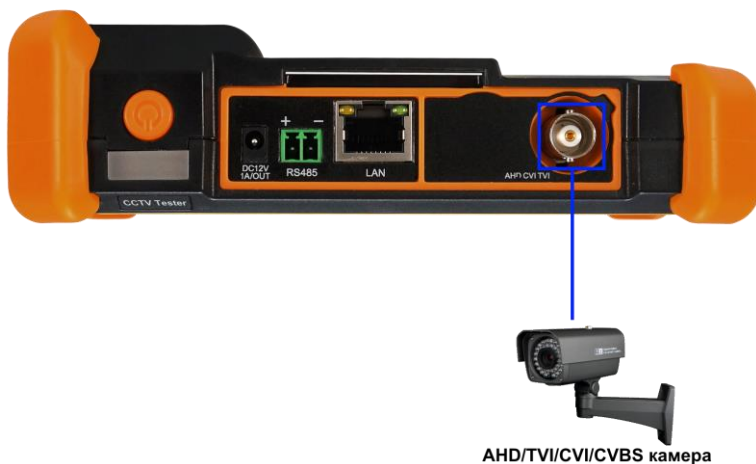
Рис.2 Разъем для подключения AHD/CVI/TVI/CVBS видеокамер
