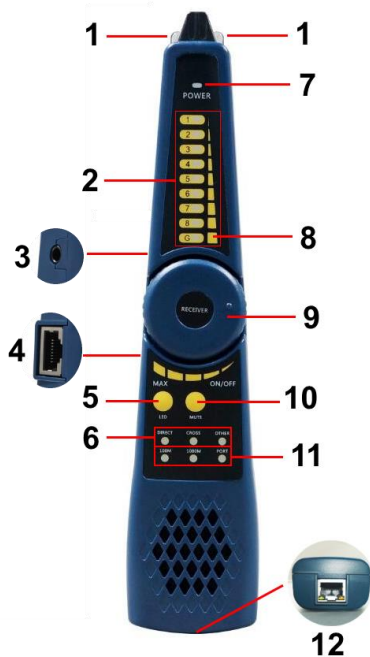
Рис. 100 Мультифункциональный щуп, разъемы и индикаторы
