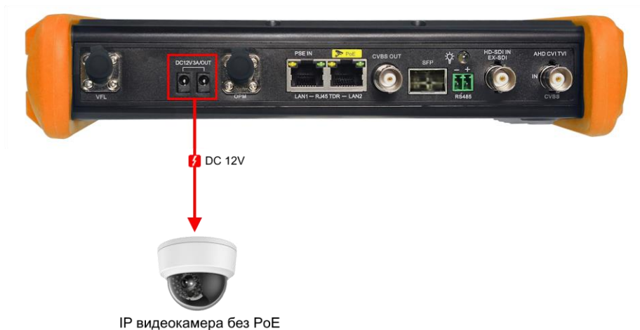
Рис. 19 Подключение питания к IP видеотекамере без PoE (на примере тестера TIP-H-7Pro)
