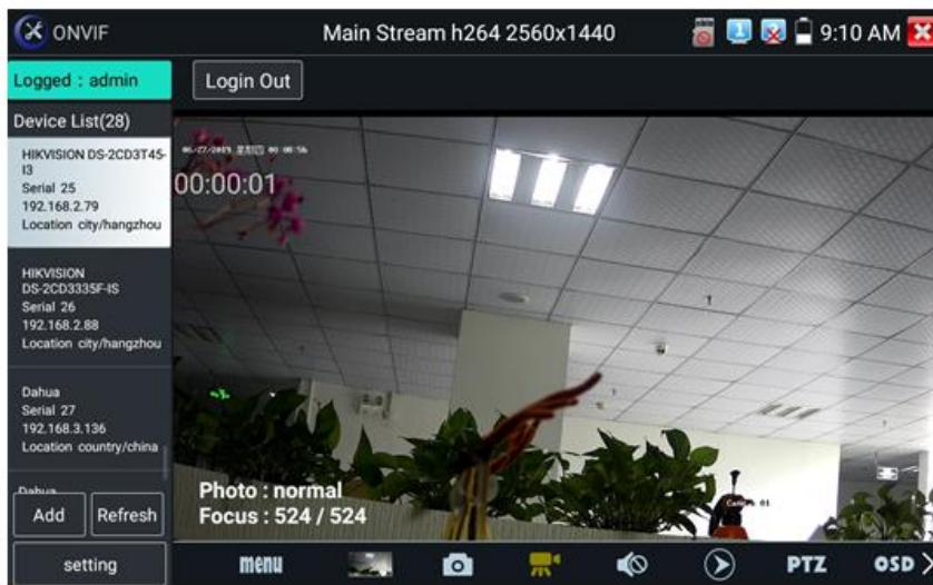
Рис. 26 Пример успешного подключения IP-видеокамеры к тестеру через ONVIF
