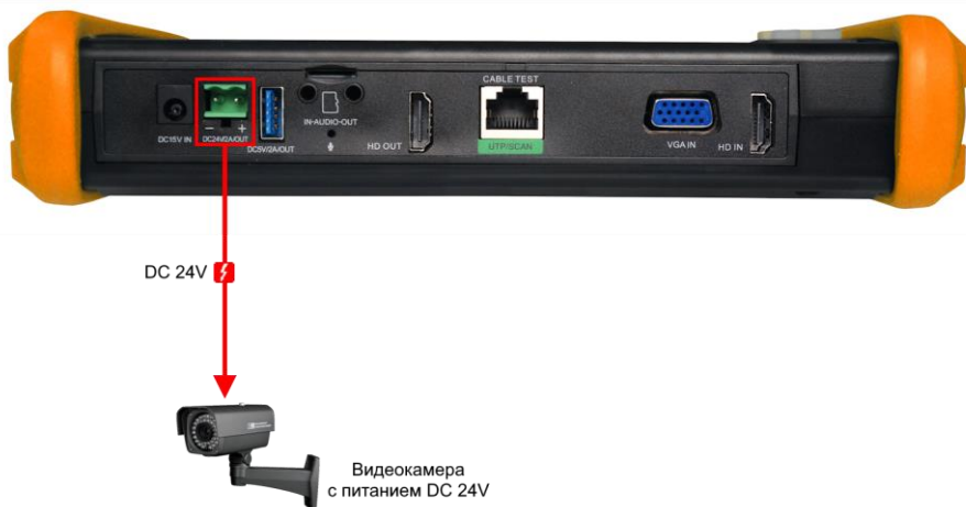
Рис. 5 Подключение питания DC 24V к мощной видеокамере с использованием тестера (на примере тестера TIP-H-7Pro)
