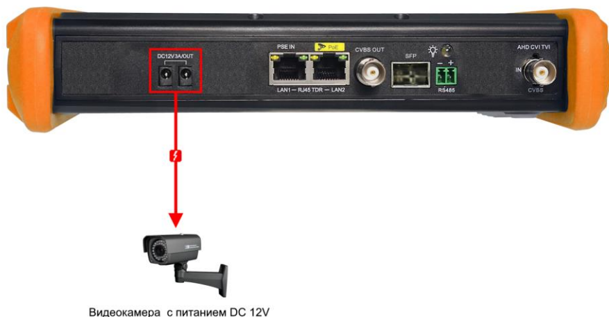
Рис. 4 Подключение питания DC 12V к видеокамере с использованием тестера (на примере тестера TIP-H-7Pro)
