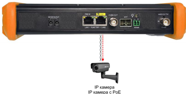
Рис. 17 Подключение IP-видеокамеры (на примере тестера TIP-H-7Pro)
