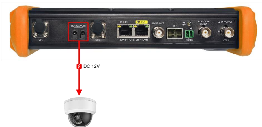
Рис. 14 Подключение питания к видеокамере HD-SDI или EX-SDI (на примере тестера TIP-HOL-MT-7Pro)
