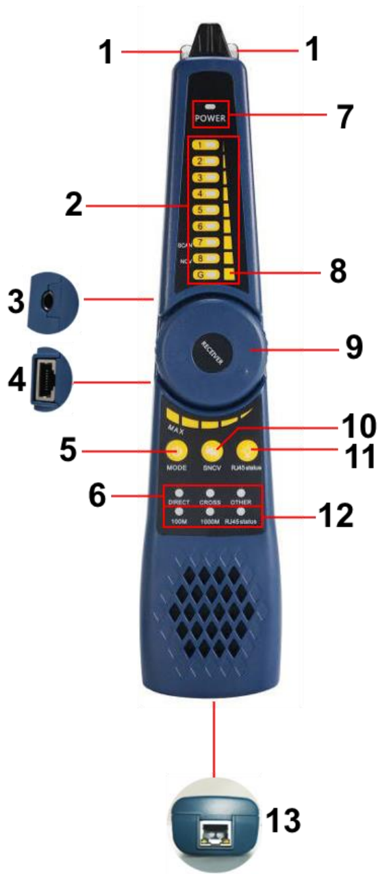
Рис. 31 Мультифункциональный щуп, разъемы и индикаторы
