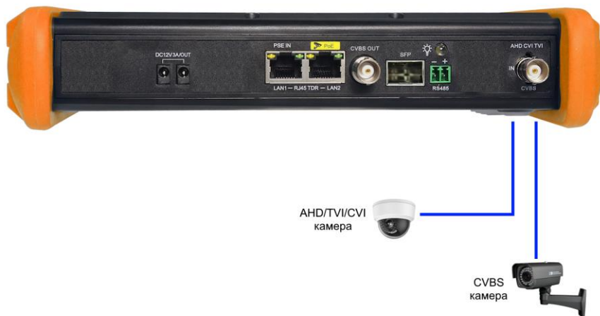
Рис.2 Подключение AHD/CVI/TVI и CVBS видеокамер (на примере тестера TIP-H-7Pro)
