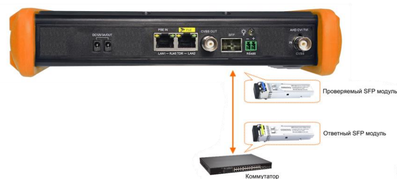
Рис. 32 Подключение SFP модуля к тестеру (на примере модели TIP-H-7Pro)
