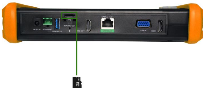
Рис. 34 Установка карты в Micro SD слот (на примере модели TIP-H-7Pro)
