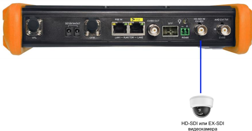
Рис. 12 Подключение HD-SDI или EX-SDI видекамеры к тестеру (на примере тестера TIP-HOL-MT-7Pro)
