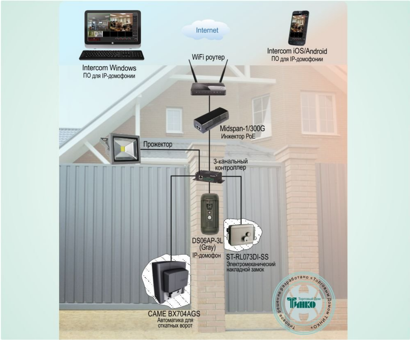
Схема построения IP-домофонной системы
