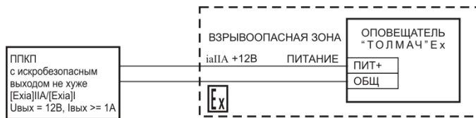
Рис.1 Подключение оповещателя «Толмач» Ex к искробезопасным выходам ППКП.
