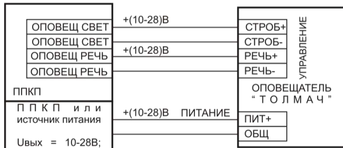
Рис. 2. Типовая схема подключения оповещателя «Толмач»П-Р с запуском по управляющему сигналу
