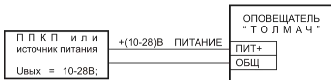
Рис. 1. Типовая схема подключения оповещателя «Толмач»П-Р с запуском по питанию
