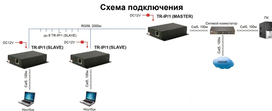
Рис. 6 Схема подключения TR-IP/1(MASTER) и TR-IP/1(SLAVE) для организации удаленного сегмента сети.
