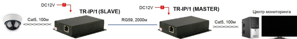
Рис. 8 Схема подключения TR-IP/1(MASTER) и TR-IP/1(SLAVE) для организации видеонаблюдения в лифте.
