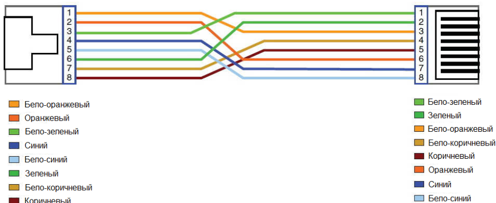
Рис. 11 Разводка кабеля по типу TIA/EIA-568-B.
