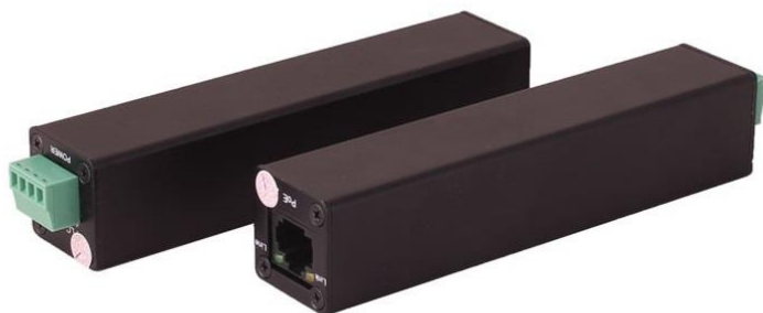
Рис.1 Удлинитель TR-IP1PoE(500м) передатчик и приемник (общий вид)
