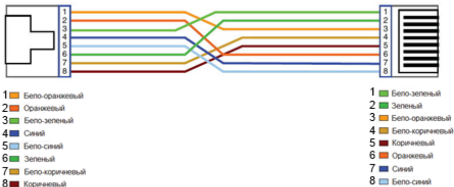
Рис. 12 Разводка кабеля по типу TIA/EIA-568-B.
