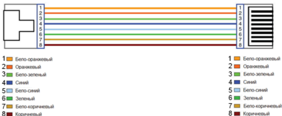
Рис. 10 Разводка кабеля по типу TIA/EIA-568-A.
