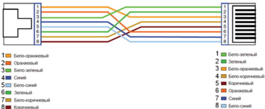
Рис. 12 Разводка кабеля по типу TIA/EIA-568-B.
