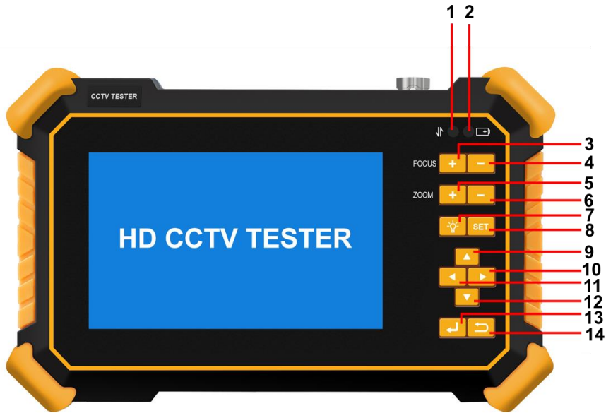
Рис. 5 Тестер TSH-H-4,3, разъемы кнопки и индикаторы на передней панели
