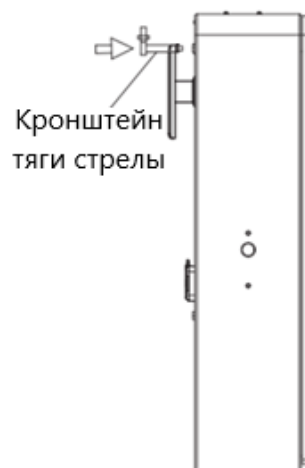
Рисунок 2.27 Установка тяги стрелы
