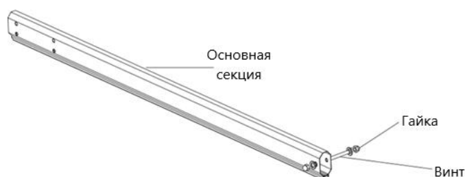
Рисунок 2.22 Разбор монтажных креплений
