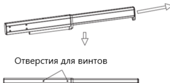
Рисунок 2.15 Выдвижение малой части стрелы
