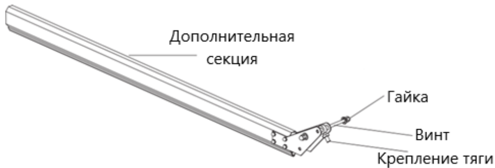
Рисунок 2.23 Разбор монтажных креплений второй части стрелы
