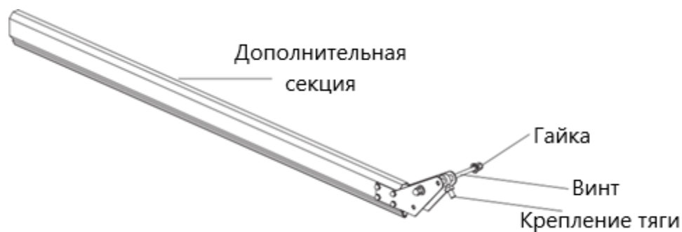
Рисунок 2.23 Разбор монтажных креплений второй части стрелы
