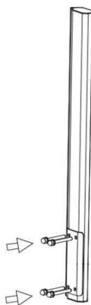
Рисунок 2.6 Установка фиксирующей планки
