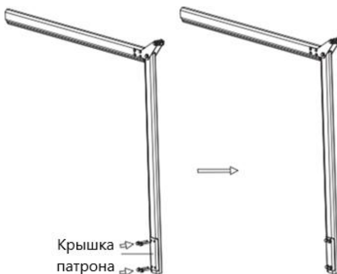
Рисунок 2.29 Установка фиксирующей планки
