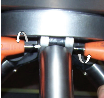
3. Затяните винты (шестигранник 5 мм)
