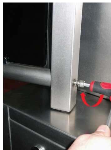
3. Затяните нижний винт
