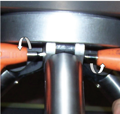
3. Затяните винты (шестигранник 5 мм)
