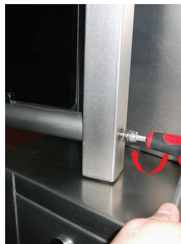
3. Затяните нижний винт
