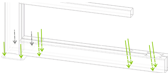
Места для анкеров в каркасе турникета
