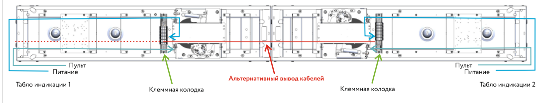
Схема ввода кабелей
