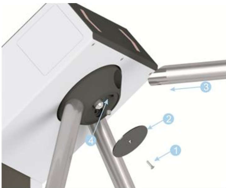
Рисунок 7.5.1 - Установка преграждающей планки
