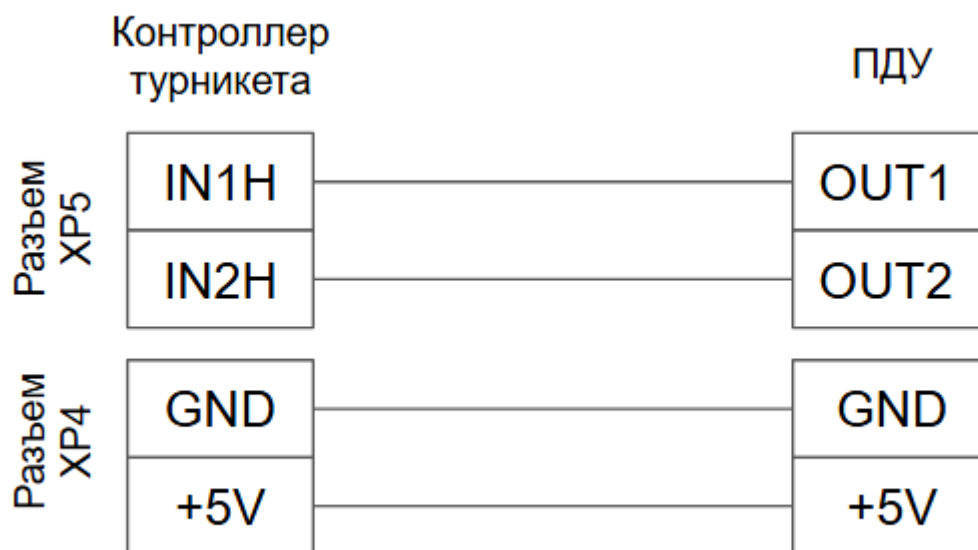
Рисунок 8.1.1 Подключение ПДУ к турникету
