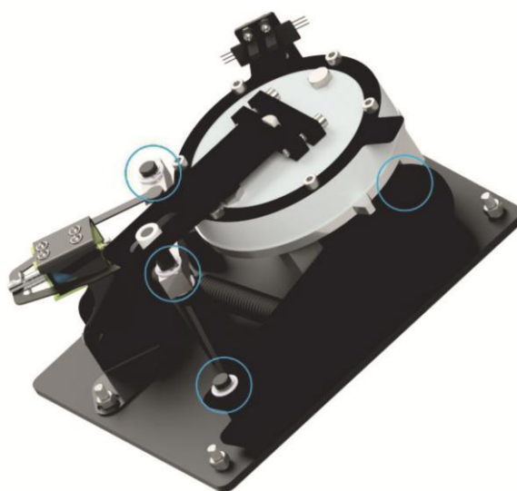
Рисунок 12.5.1 - Места смазки подвижных частей
