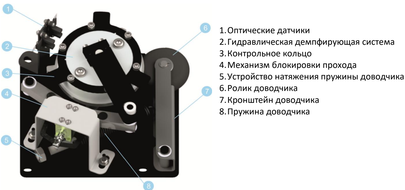
Рисунок 6.2.1. - Устройство механизма турникета
