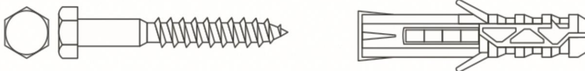
Рисунок 7.4.1 - Шуруп с шестигранной головкой «Глухарь» с дюбелем
